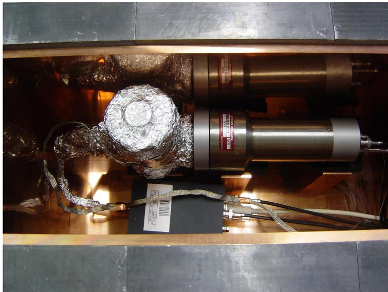
図 3.3: InP 半導体検出器と CsI シンチレータ (向かい合わせにしたもの)
