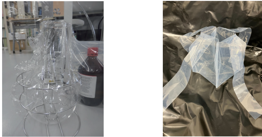
図 2.3: 丸底フラスコ (左) と ETFE バッグ (右)
