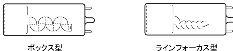
図 2.8: PMT の電子増倍部の型 ([18] より引用)
