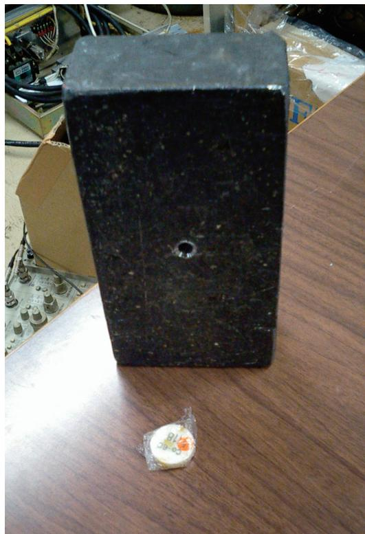
図 2.5: コリメータに使用した鉛と  $^{60}\text{Co}$  線源
